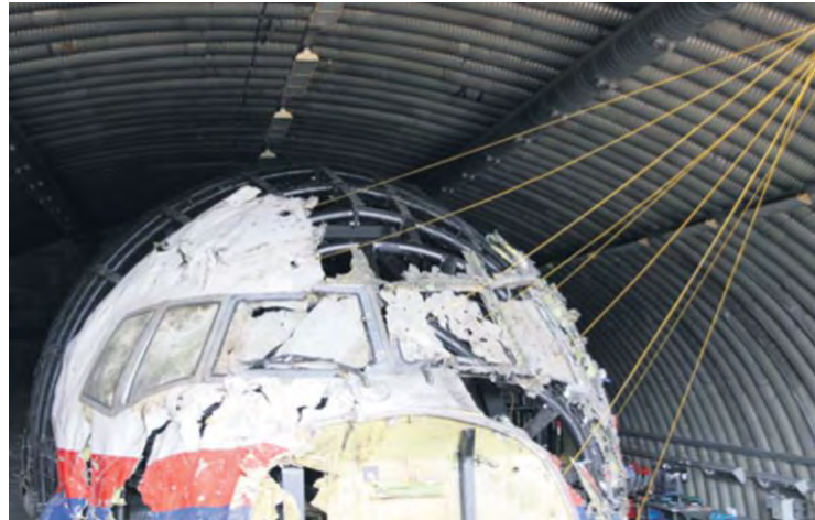
תא הטייסים כפי ששוחזר בהולנד, החוטמים מייצגים את הנתיב המשוער של רסיסי הטיל (תצלום מתוך דוח החקירה ההולנדי)
